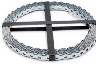
Profilband FBP används vid upphängning av rör, ventilationstrummor och kabelstegar. Ej för bärande konstruktioner. För fastsättning används rostfri ankarspik 4,0 eller rostfri ankarskruv 4,8.
