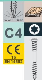
Trallskruv avsedd för tryckimpregnerat virke. Dubbel gänga som dels gör det möjligt för skallen att försänkas i hårdare träslag och dels håller virket på plats med hjälp av gängorna och inte med skallen. Den cylinderformade skallen skär rakt ner i träet och ger ett utmärkt resultat. Försedd med fiberskärande borrspets.
