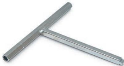
T-nyckel är främst avsedd att för hand finjustera fönster- och dörrkarmar efter montering. T-nyckel går naturligtvis också att använda vid montering av karmskruv. Vid montering används änden med en invändig sexkant, som då greppar både hylsan och skruven vid skruvning. Vid justering används änden som är urborrad invändigt, som då bara greppar hylsan vid skruvning. Den fyrkantiga delen är till för att kunna öppna fönster och dörrar utan handtag. Ger också en bra hävarm vid montering/justering.
