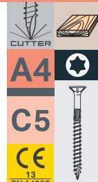
Utvändig träskruv med cutterpets, stamfräs och försänkt skalle med riller. Stamfräs finns på alla längder från 50 mm och uppåt. d = delgängad. Kan användas både inom- och utomhus. Material: Rostfri Syrafast A4 stål, korrosivitetsklass: C5.
