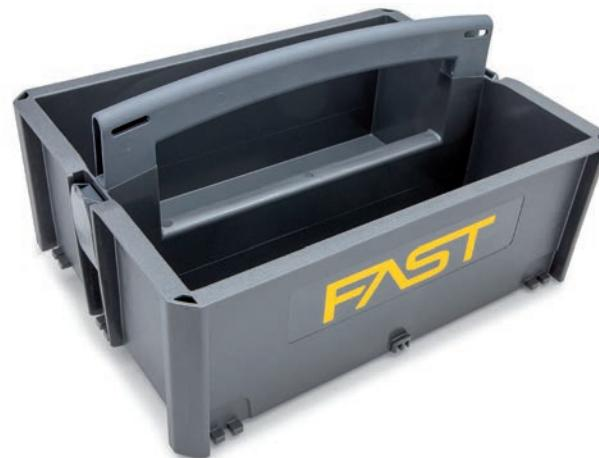
FAST Systainer® Toolbox bygger på ett etablerat system. FAST Systainer® Toolbox består av två öppna fack med en låg avdelare för snabb förvaring av verktyg, arbetsmaterial och tillbehör. Ergonomiskt handtag för lett hantering. Sammankopplas enkelt med FAST Systainer® och ger en flexibel förvaringslösning för fästelement och tillbehör. Mått: H143xB396x296 mm. Höjd inkl handtag: 208 mm. Vikt: 1,3 kg.
