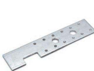
Balkankare JA används vid infästning av träbjälkar, takstolar och hammarband till stålbara med flänsar. För fastsättning används ankarspik 4,0, ankarskruv 4,8 eller M12-bult.
