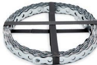
Profilband FBP används vid upphängning av rör, ventilationstrummor och kabelstegar. Ej för bärande konstruktioner. För fastsättning används ankarspik 4,0 eller ankarskruv 4,8.
