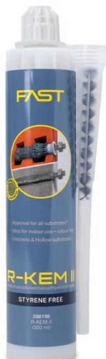
Två komponenter, högpresterande, styrenfri polyesterankarmassa. Idealisk för applikationer där konventionella infästningar inte fungerar. För användning i ej sprucken betong, alternativ 7. Kan även installeras i fuktig betong. ETA godkänd för 15 olika underlag - ETA-12/0528. Efter tubens öppnande kan ankarmassan användas i upp till sex månader om man låter nosröret sitta kvar på patronen. Sätt bara på nytt nosrör vid nästa användning. **OBS!**
