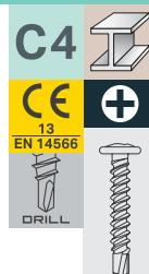
Avsedd för montage av utegips på stålregel max 2,0 mm. Anpassat huvud till de krav som ställs för montage av utegips. Ytbehandling: E-Coat. Korrosivitetsklass: C4.
