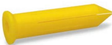
Clipspluggen expanderar när man slår in en spik i den. Därför passar den utmärkt när man monterar clips och spikklammer i betong, lättbetong, tegel eller gips. Material: Polystyren.
