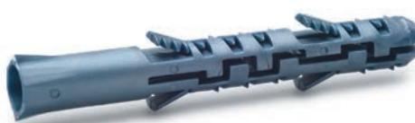
Avsedd för montage i porösa material som lättbetong, lättklinker (Leca) och hålsten. Vingar och 8-kantig hals förhindrar att pluggen roterar under montage. Material: Nylon.
