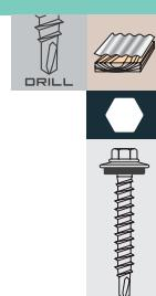
Borrar, gängar och skruvar i ett montage. Skruv avsedd för montage av aluminiumplåt i trä. Konad under skallen för tätning. Borrkapacitet 2x1,5 mm. Sexkantskalle med fläns. Bricka med tätning av EPDM-gummi.
