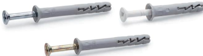
Avsedd för montering av reglar, socklar, skåp, köksinredningar m.m i lättbetong, tegel, hålsten m.m. ETA-godkänd ETA-12/0457. Material: Nylon. Ytbehandling: Elförzinkad.
