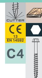
Avsedd för tyngre montage av trä, spånskivor, plywood m m. Försedd med 6-kantshuvud med fläns och cutter-spets. Ytbehandling: Zinkflakes, korrosivitetsklass: C4.
