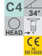
För spikning av tak- och väggskivor, råspont, utvändig panel, stomme eller konstruktion. Pappbandad 34°. Med rund offset skalle. Diamantspets. Ytbehandling: TDG, korrosivitetsklass C4.
