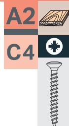
Kullerförsänkt skalle med bits kryssspår. Användningsområden: För infästningar i t ex badrum, toaletter och andra våtutrymmen. Ger ett bra korrosionsskydd. Helgängad. Material: Rostfritt stål A2.
