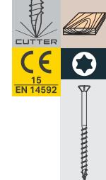
För infästning av spånskivor på träregel. Försedd med cutterspets och rillor under huvudet som fräser och försänker. Ytbehandling: Elförzinkad.
