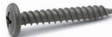
Avsedd för montage av utegips på trå- och stålregel max 1,0 mm. Anpassat huvud till de krav som ställs för montage av utegips. Ytbehandling: E-Coat. Korrosivitetsklass: C4.
