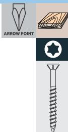
För sammanfogning av MDF-skivor. Självborrande spikspets gör att ingen förborring krävs och minimerar sprickbildning. Försedd med delvis sågtandad gänga samt rillor under skallen som försänker. Ytbehandling: Elförzinkad.
