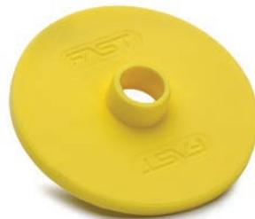
Avsedd för användning tillsammans med karmhylsa. Tryckfördelningsbrickan fästs i hylsan vid montage av tunga tråkarmer eller vid infästning av karm mot lättbetong, leca och håltegel.
