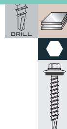
Borrande skruv för montage av plåt mot lättbalk. Borrar, gängar och skruvar i ett moment. Borrkapacitet: 1,5-5,0 mm. Ytbehandling: Elförzinkad 20µm + pulverlack.
