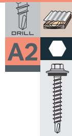
Rostfri borrande och gängpressande skruv för utvändig infästning av byggnadspåt. Borrspets av härdat stål. Sexkantskalle med fläns. Ledad bricka med tätning av EPDM-gummi. För træregel. Material: Rostfritt stål A2.
