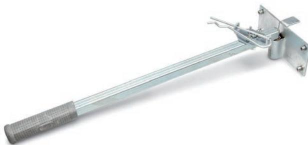
Bandsträckare BRT används för att kunna spänna bandet vid montering av dragband. Kan användas till dragband som har en bredd från 25 till 60 mm. Viktigt att tänka på är att förbanden utförs på rätt sätt så att förbindningen inte ger efter även när virket krymper. Band till träkonstruktioner ska sträckas ut ordentligt och samtliga virkeskanter som bandet bockas över ska avrundas.
