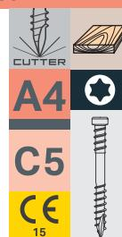
Avsedd främst för användning i hårdare träslag. Dubbel gänga som dels gör det möjligt för skallen att försänkas i hårdare träslag och dels håller virket på plats med hjälp av gängorna och inte med skallen. Den cylinderformade skallen skär rakt ner i träet och ger ett utmärkt resultat. Fungerar även ypperligt i tryckimpregnerat virke. Försedd med fiberskärande borrspets. I hårdare treslag krävs förborring. Material: Rostfritt syrefast stål, A4. (AISI316)
